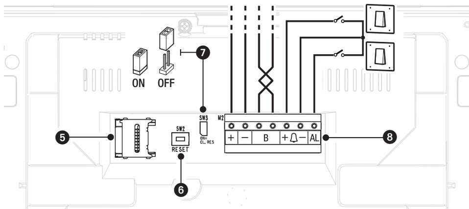
**7** Концевой резистор. Переключатель должен быть установлен только на последнем устройстве линии.
